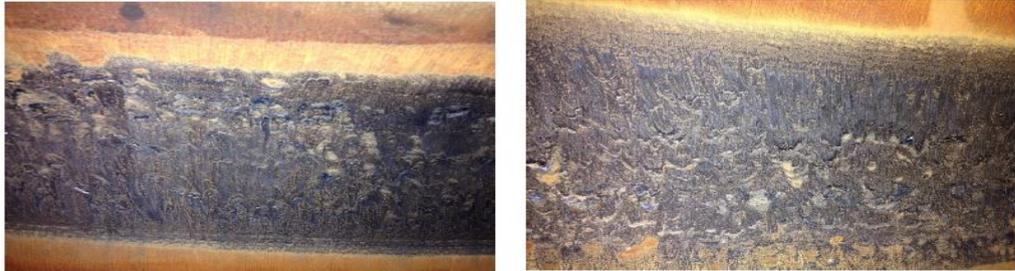
Figura 10 – Imagem de desgaste do disco do laminador
