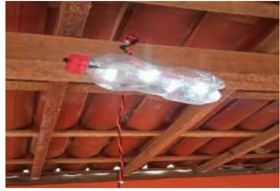
Figura 12 - Lâmpadas artesanais de LED, na comunidade de Três Irmãos. Foto: SEBRAE RN.
